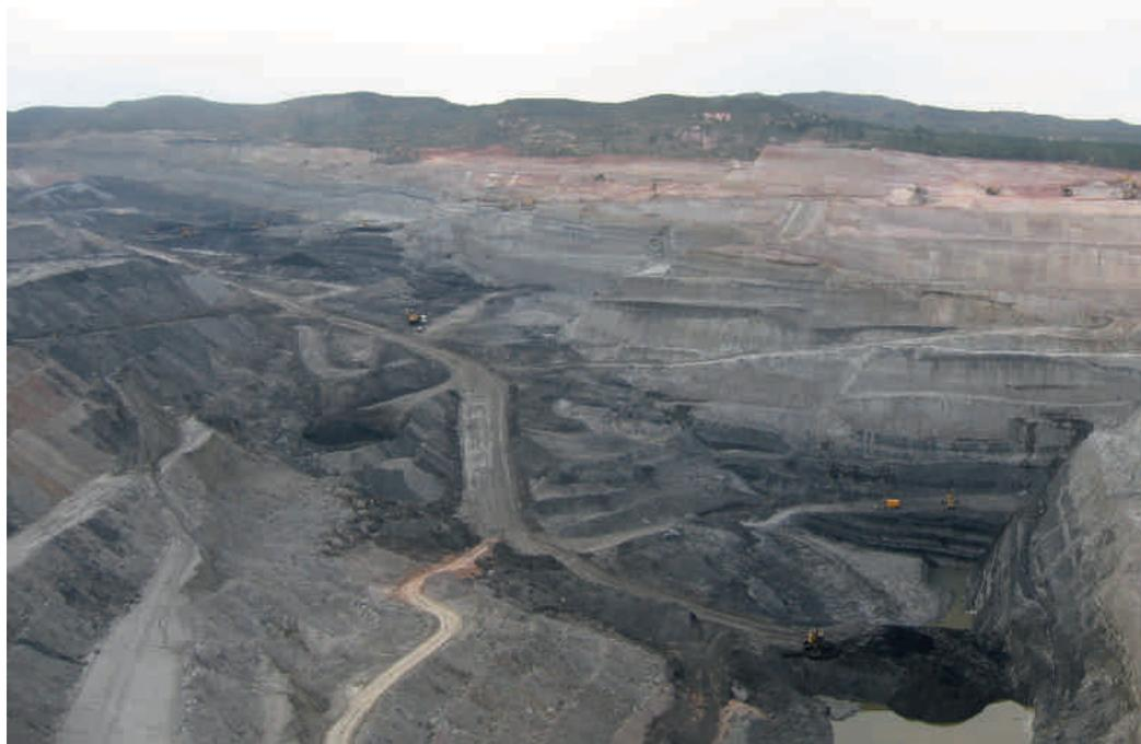
Explotación a cielo abierto de carbón de la Formación Escucha (Cretácico inferior) en Gargallo. A la izquierda se observan las capas de carbón con buzamiento subhorizontal y a la derecha, las capas blancas de la Formación Utrillas sobre ellas
