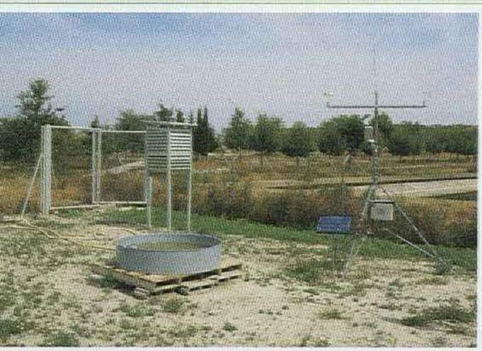
**Estación agrometeorológica.** Instrumentación manual y electrónica instalada en Monegros.
