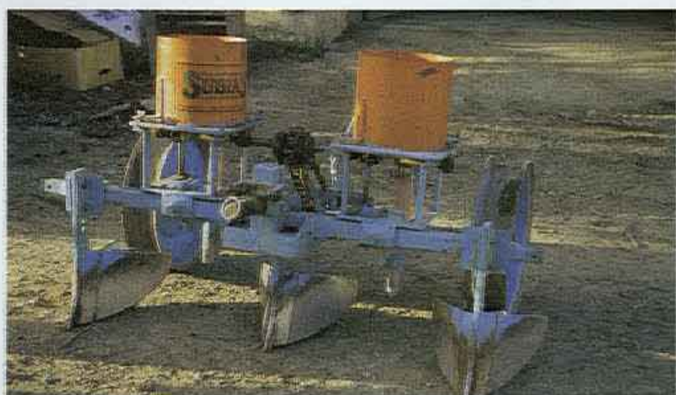
Sembradora utilizada en borraja adaptada para motocultor.
