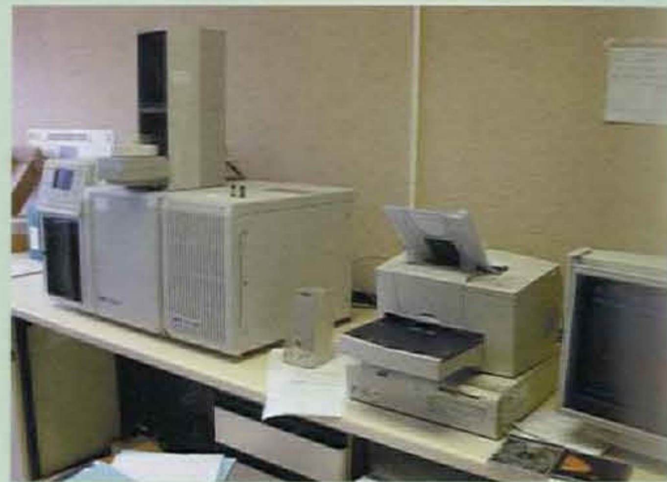
Cromatógrafo de gases con detector de espectrometría de masas capaz de detectar una parte en un trillón de partes de restos de pesticidas.
