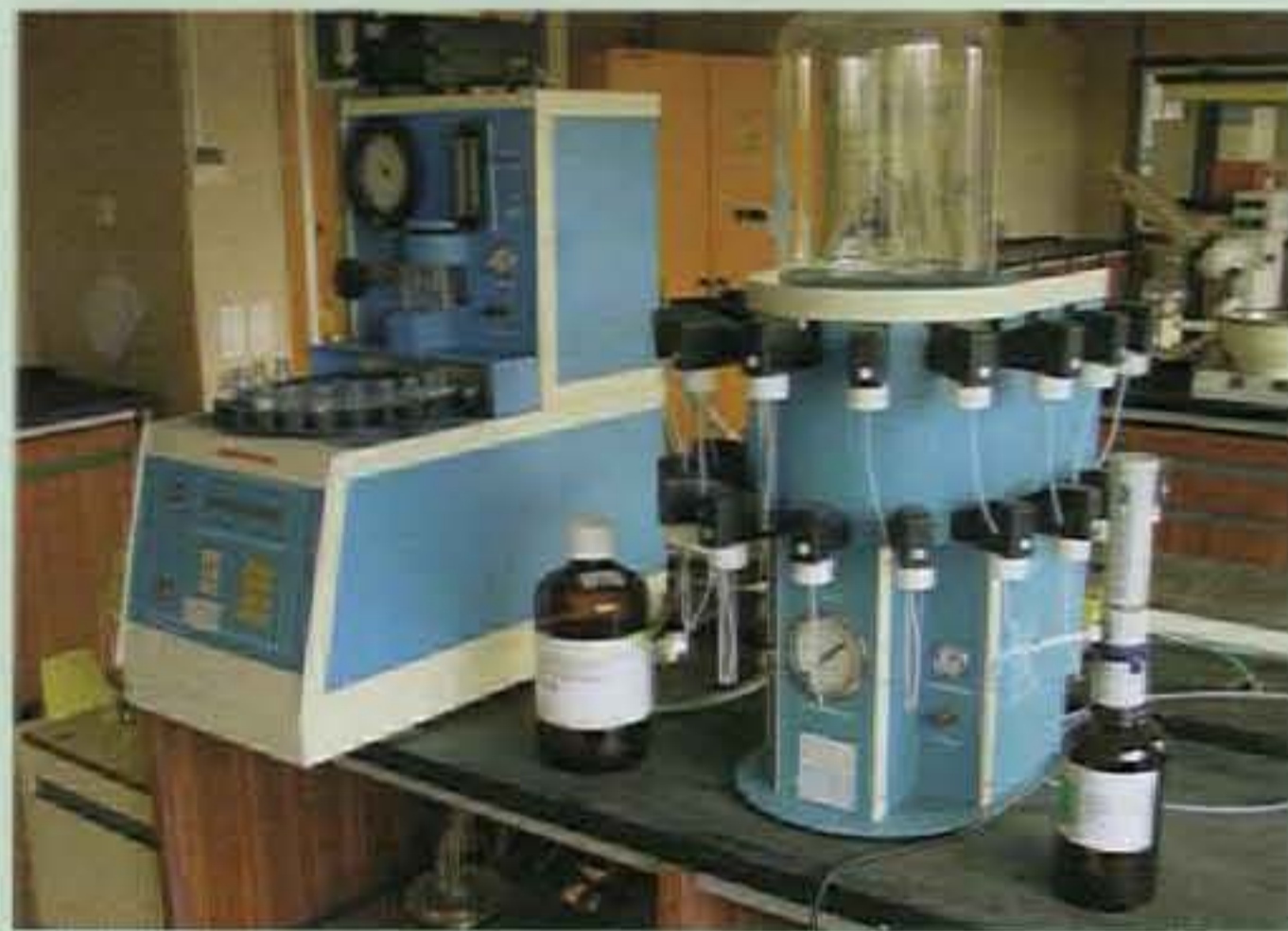
Equipo para la extracción con disolventes orgánicos de residuos de pesticidas.
