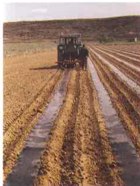
Foto 1. Máquina acolchadora de tomate
