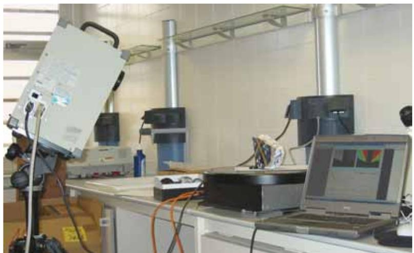
Escaneado de fragmento de pintura mural mediante un equipo 3D de Minolta.
