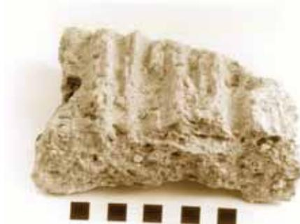
Detalle de los estratos del mortero y de la impronta de cañas
