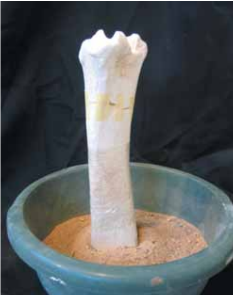
Fig. 7. Proceso de adhesión a través de la cama de arena
