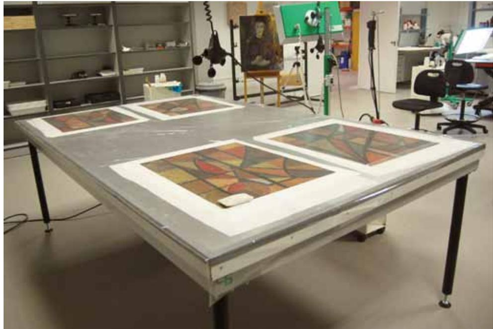
Eliminación de las deformaciones del papel mediante la mesa de succión
