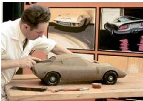
Maquetas realizadas en clay para el diseño del Opel GT.
