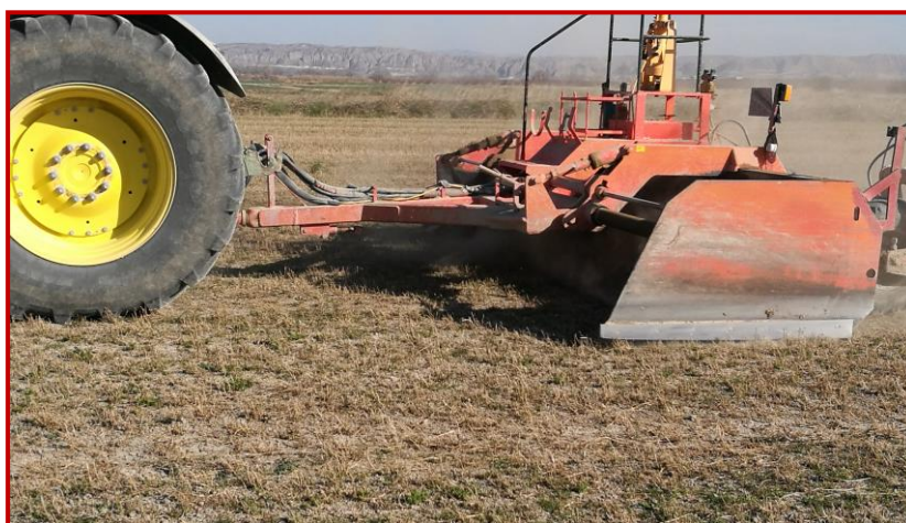
Labores de corte invernal con niveladora en Fuentes de Ebro
