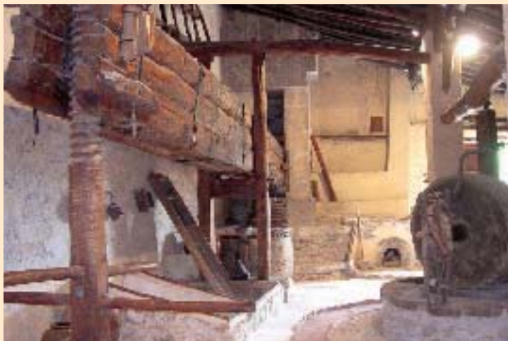
Magnífico ejemplo de prensa tradicional de viga conservado en la almazara de Jaganta
