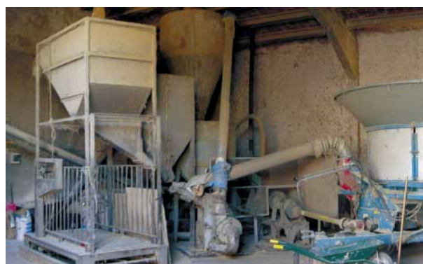
Fig. 5. Sencillo equipo para la preparación de pienso molido ad libitum (Fuentes de Ebro).
